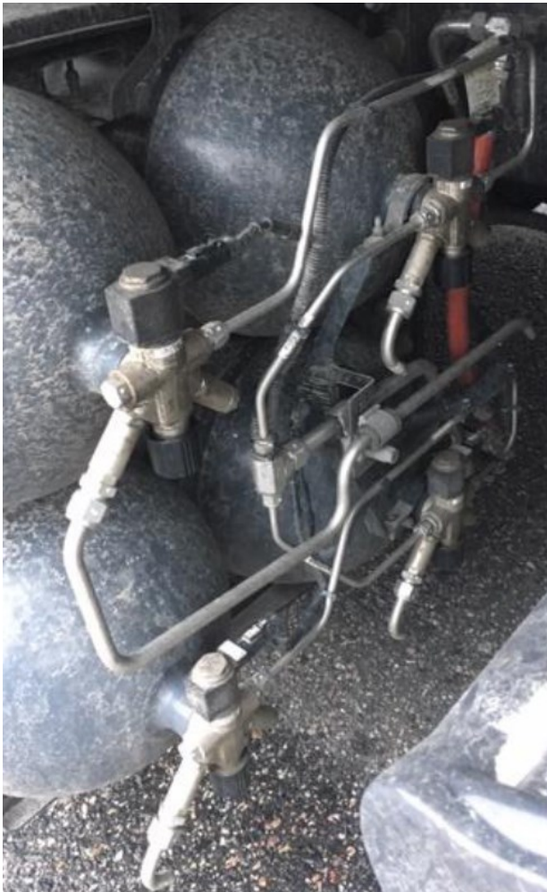
KUVA 13 CNG-säiliöiden venttiilit (Vaihtoehtoiset energiaratkaisut kuorma-autoihin)
