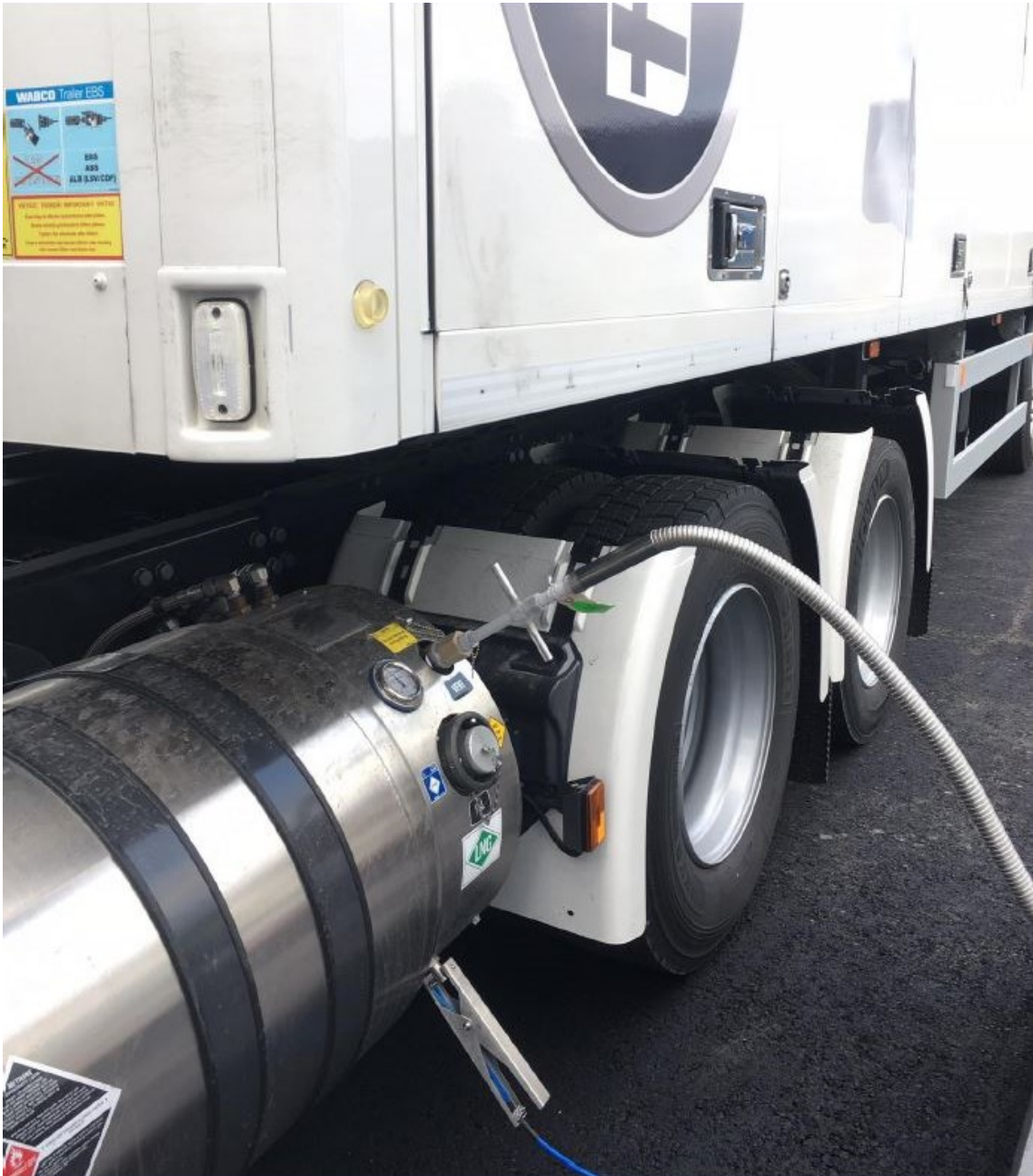
KUVA 5. LNG-kuorma-autoon kytkettynä kaasunpoistoletku ja maadoitusjohto (Vaihtoehtoiset energiaratkaisut kuorma-autoihin)
