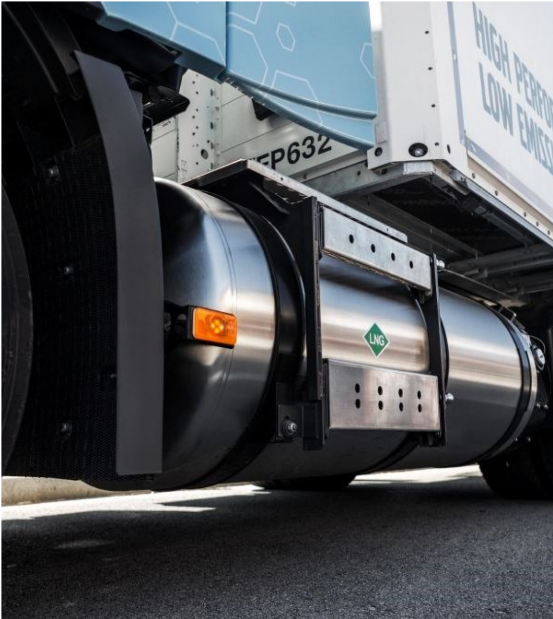
KUVA 2. Kuorma-auton LNG-termossäiliö (Vaihtoehtoiset polttoaineet. 2018)
