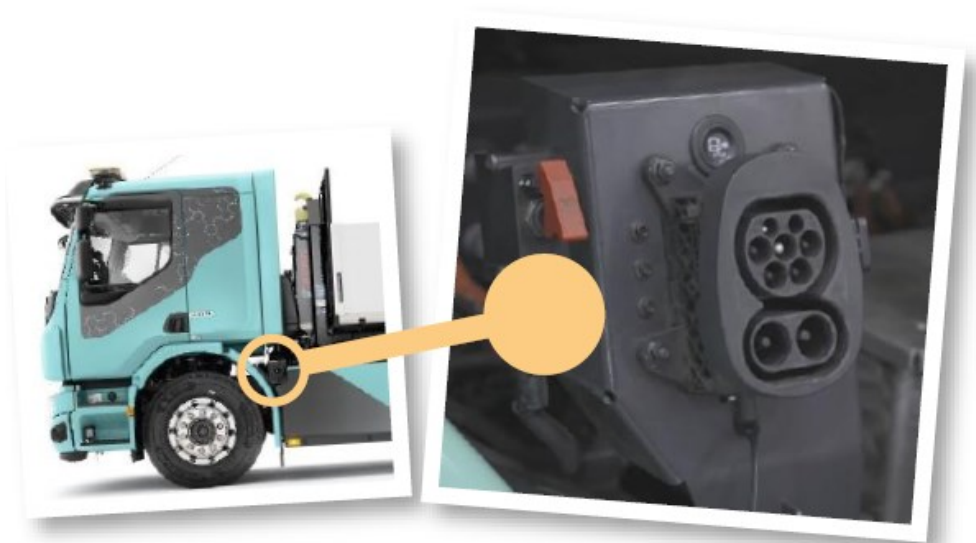
KUVA 21. Latausliitäntä Volvon sähkökuorma-autossa (Volvo Electric)
