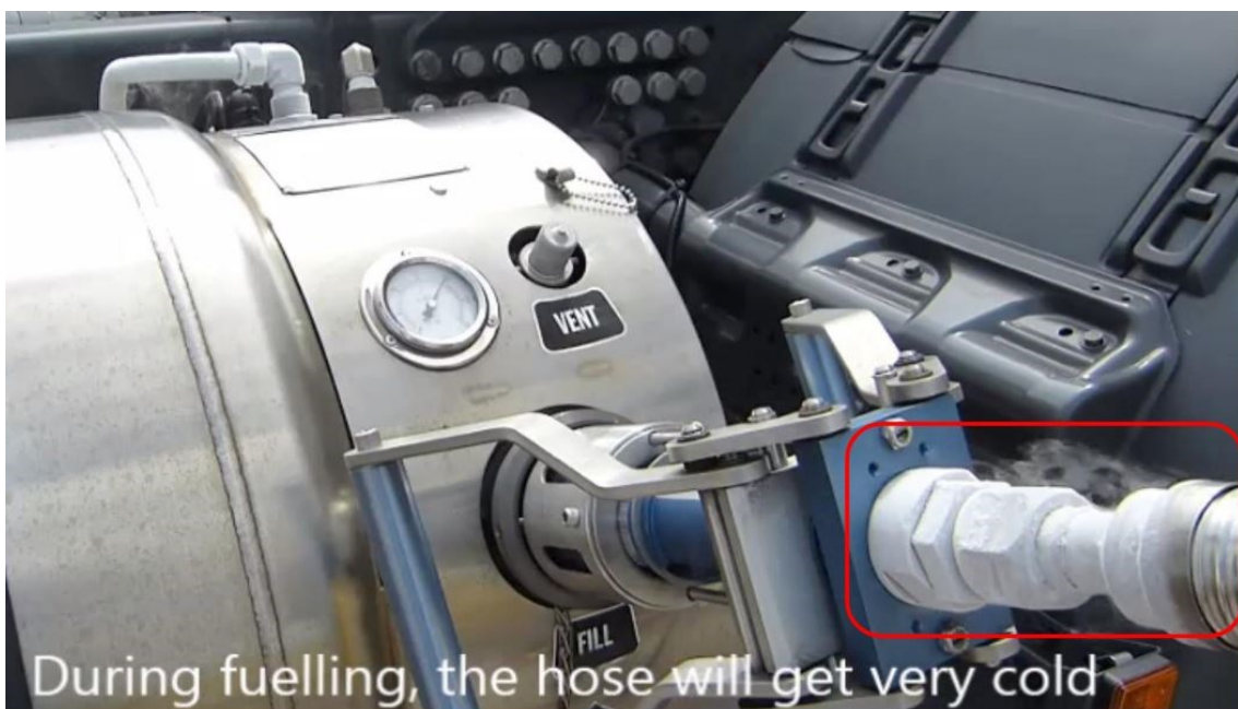
KUVA 7. Tankkauksessa suuttimen ja letkun osat kylmenevät voimakkaasti (Vaihtoehtoiset energiaratkaisut kuorma-autoihin)
