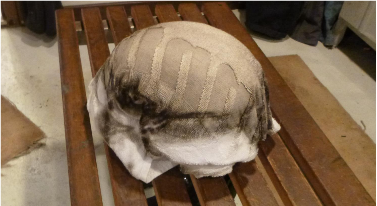
Kuva 14. Suitenhytin ilmanvaihtokoneen kattoyksiköstä löytynyt pyyhe. (Krister Lundqvist)
