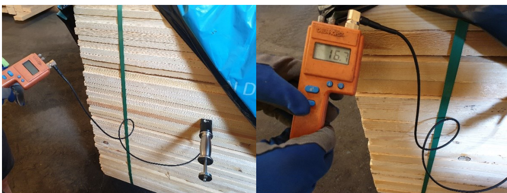
Kuva 3. Puun kosteuden selvittäminen piikkimittauksella.
