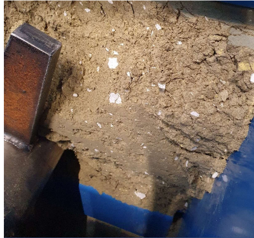
Kuva: Akustiikkalevyn pinnoitteen palasia jauhetun villan seassa noin 30 min jauhamisen aloittamisesta (Kohvakka, 2020)
