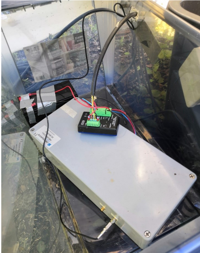
KUVA 10. Dataloggeri (harmaa) toiminnassa. Kuvassa on myös DCP Signal Output Adapter (musta) sekä 12 V akku. (Nissinen 2020.)
