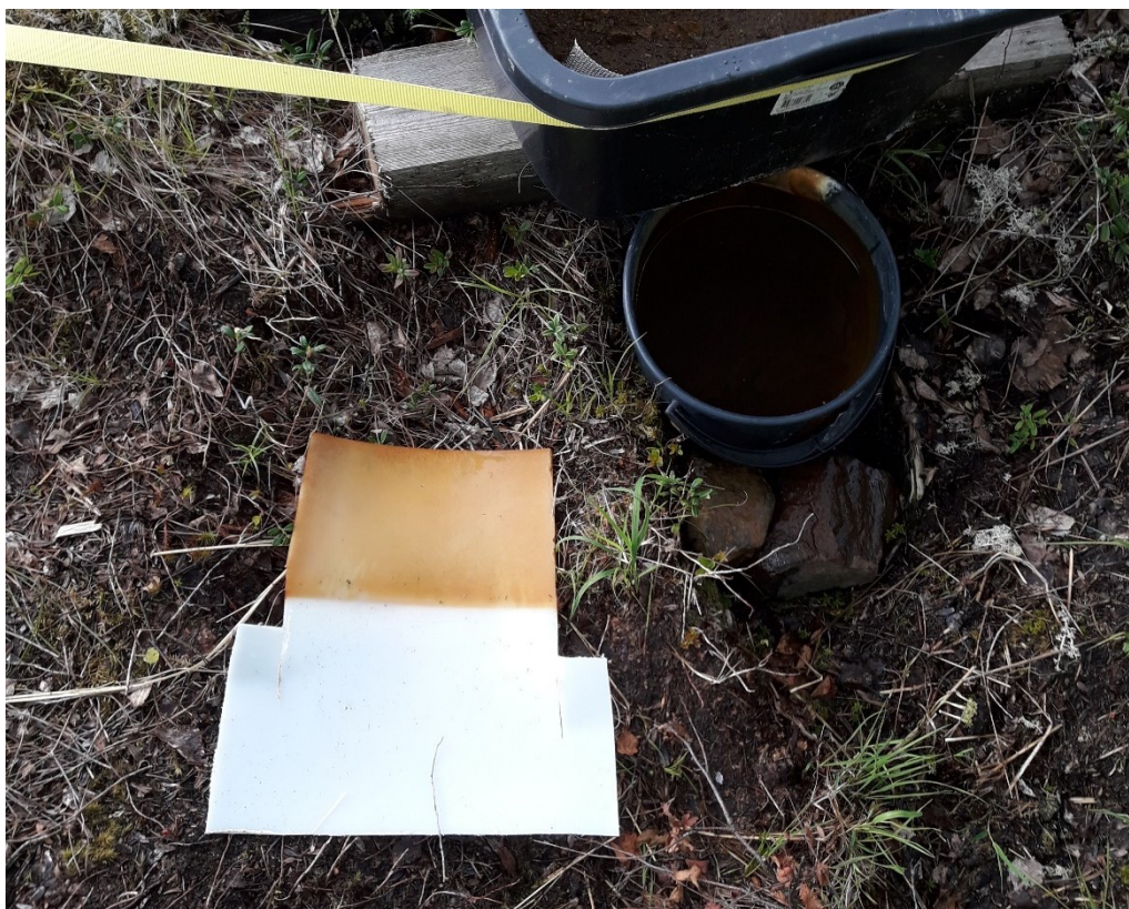
KUVA 15. Mitta-astian muovisen väliseinän värimuutos (Nissinen 2020)
