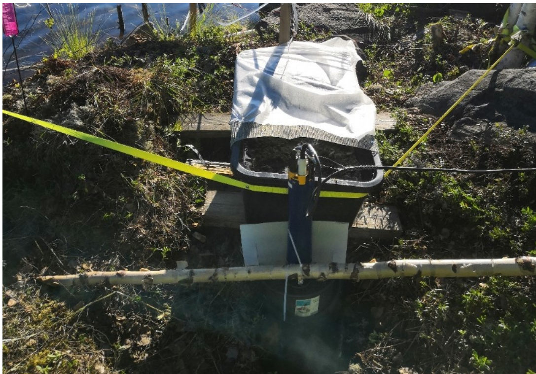
KUVA 9. YSI EXO II- mittari toiminnassa (Nissinen 2020)
