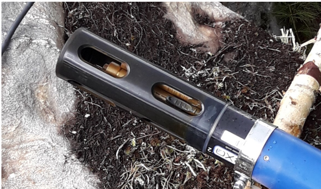
Kuva 14. YSI EXO II -mittarin mittauspää (Nissinen 2020)
