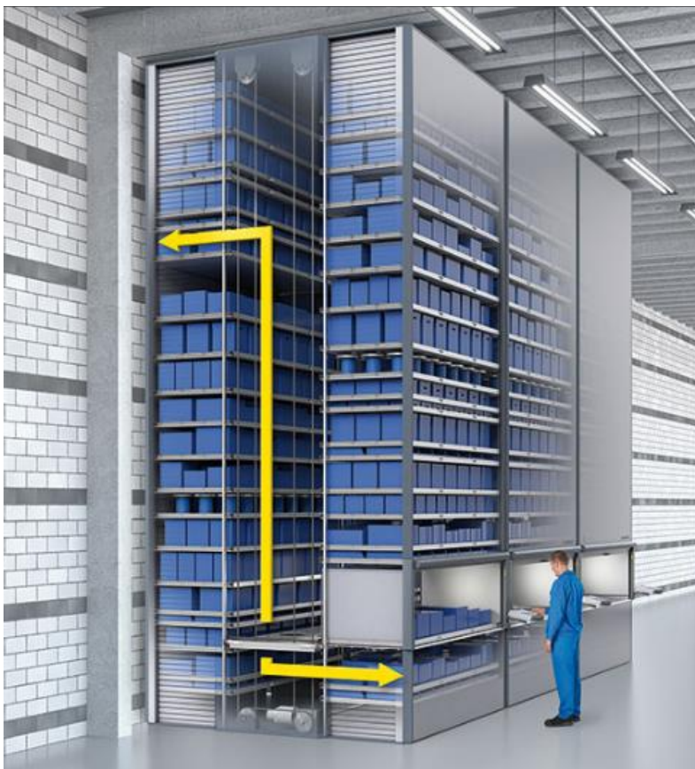
Kuva 21. Pystymallinen varastoautomaatti (ADS 2020)
