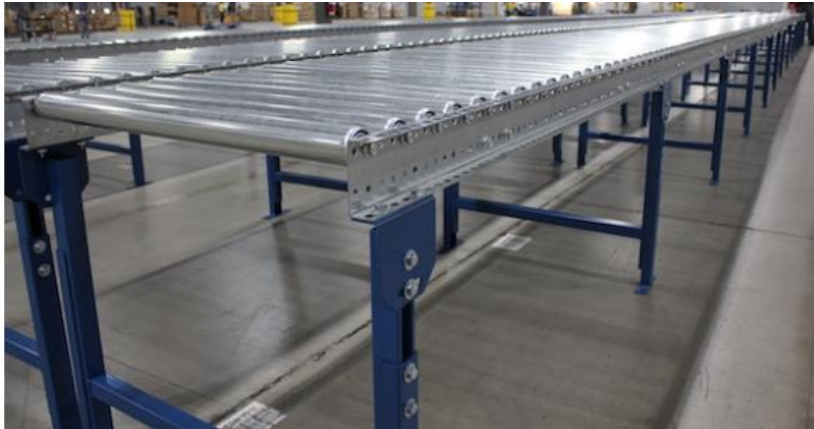
Kuva 13. Painovoimalla toimiva rullarata (Wecon systems 2020)
