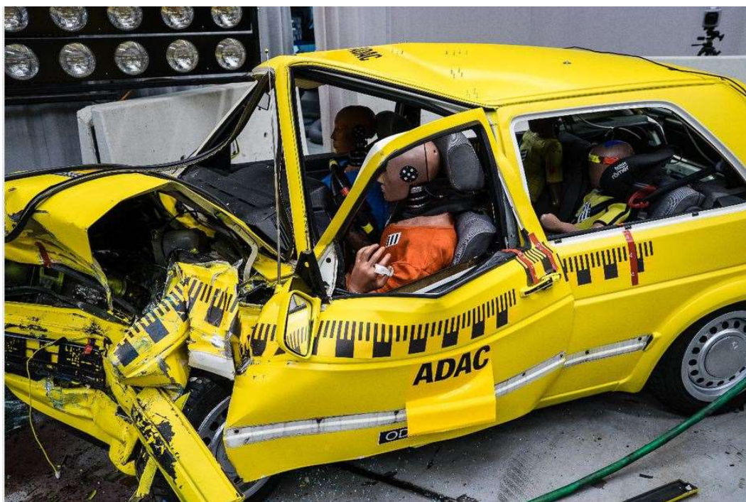
Kuva 15. Vuosimallin 1988 Volkswagen Golf MK2:n vauriot 64 kilometrin tuntinopeuden MPDB-testissä (Der ADAC lässt es krachen 2017).
