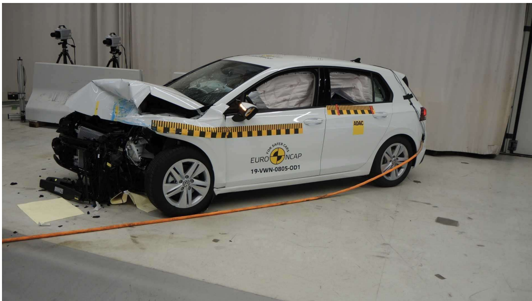
Kuva 16. Vuosimallin 2020 Volkswagen Golf MK8 vauriot 64 kilometrin tuntinopeuden MPDB-testissä (Gemelli 2019).
