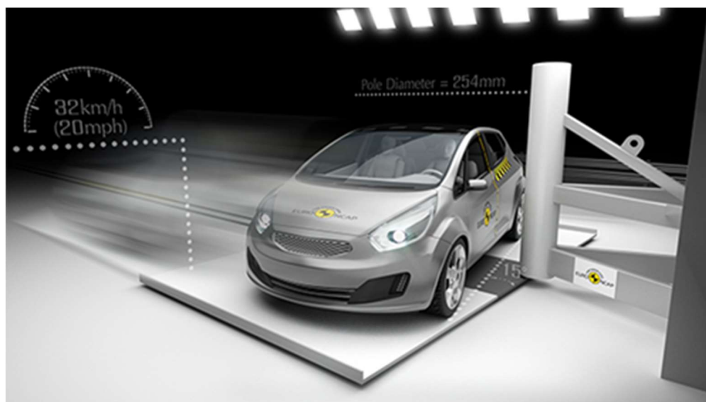
Kuva 13. Sivuttaissuuntainen törmäys tolppaan (Side Pole 2020).
