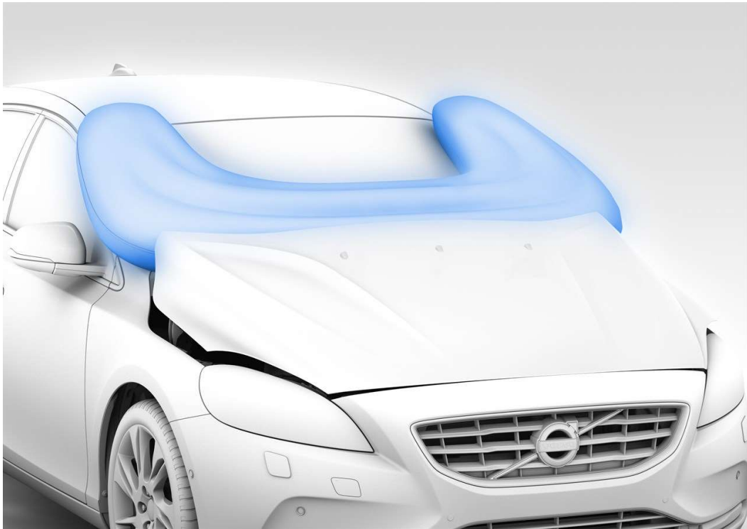
Kuva 3. Jalankulkijan turvavyyny Volvo V40:ssä (The all-new Volvo V40 – Pedestrian Airbag Technology 2012).
