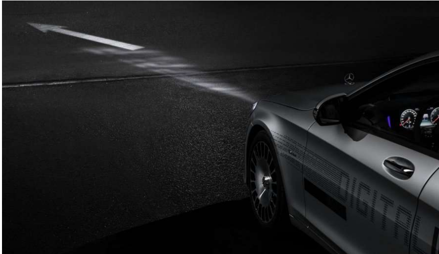
Kuva 9. Digitaalisen ajovalon heijastama opaste (High Definition headlamps with innovative features 2020).
