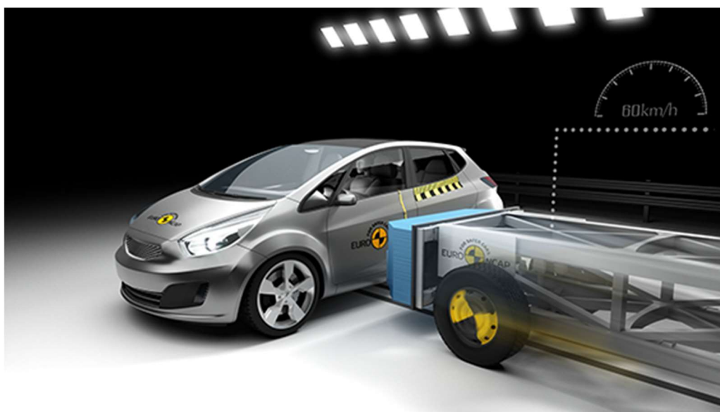
Kuva 12. Sivuttaissuuntainen törmäys paikallaan olevaan autoon (Side Mobile Barrier 2020).
