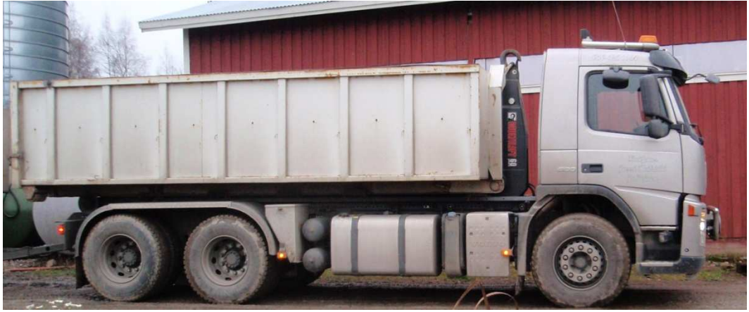
Kuva 5. Lava on laskeutunut auton rungon päälle
