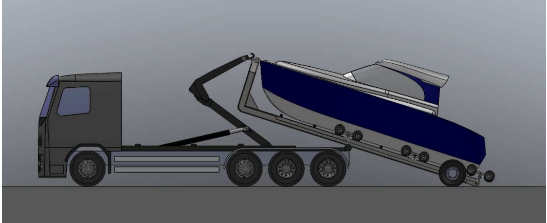
Kuva 12. Lavan takapäähän paino siirtyy rissapyöriltä kumipyörille.
