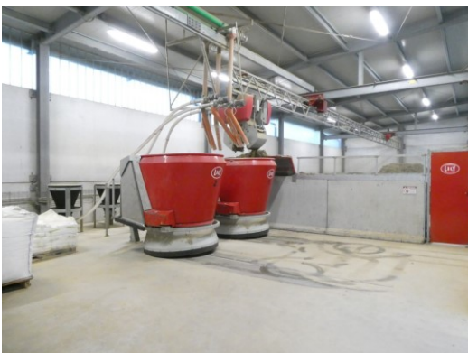
KUVIO 5. Rehukeittiö, jossa kaksi sekoitus- ja ruokintarobottia (Sohlo, L. Sähköposti. Viitattu 4.11.2020)
