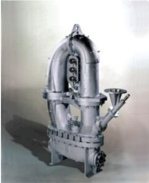
Kuva 3. Varhainen versio loop-tyyppisestä jauhimesta. (Fluid Energy 2020.)
