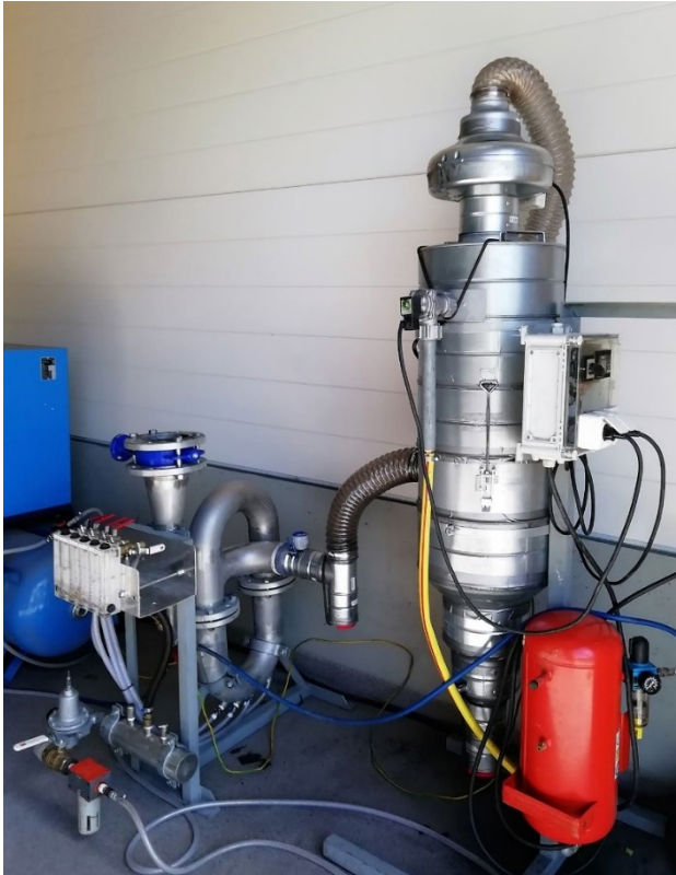
Kuva 7. Xamkin rakentaman loop-jauhimen ensimmäinen versio, jolla todettiin konseptin jatkokehityskelpoisuus. (Kuva Tomi Höök.)
