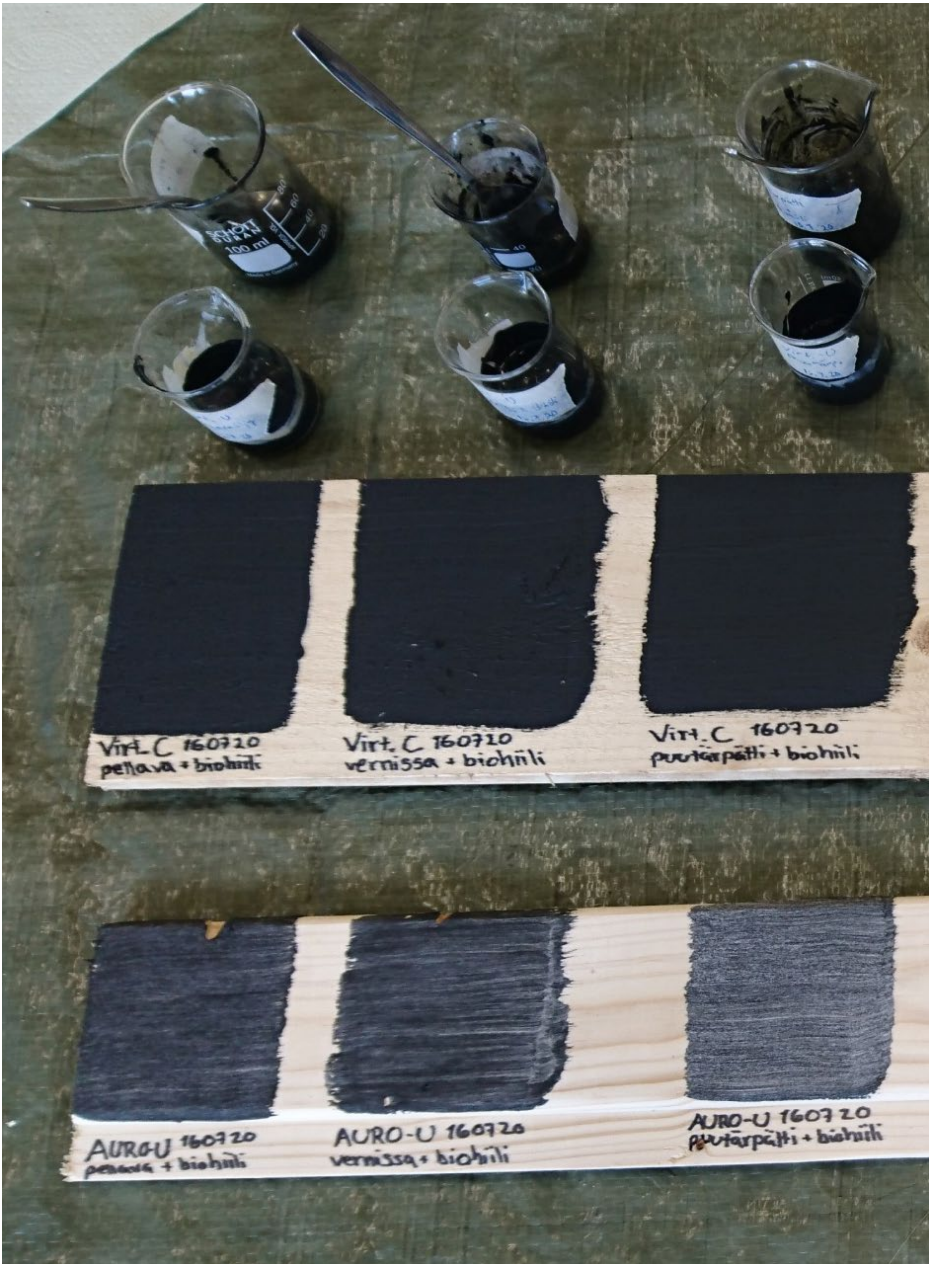
Kuva 4. Yön yli (noin 24 tuntia) vernissassa, pellavaöljyssä ja puutärpätissä "sulaneet" biohiilipohjaiset sävytyspastat tuottivat mustan lopputuloksen öljypohjaiseen Virtasen 4 öljyn maaliin sekoitettuna. Samat sävytyspastat eivät sekoittuneet vesiliukoiseen Auro-U-maaliin, jolla maalatut pinnat näkyvät alemmalla lankulla. (Kuva Tomi Höök.)
