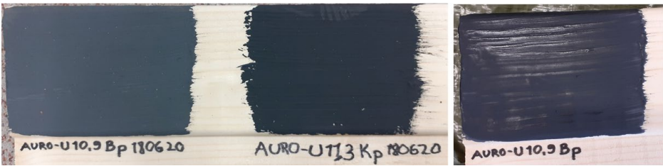
Kuva 2. Sävyttämätön vesiohenteinen maalipohja Auro-U värjäytyi tummemmaksi kuin valmis valkoinen Cello-maali mutta ei mustaksi. Vasemmalla koeala on maalattu maalilla, jossa on biohiiltä 10,9 painoprosenttia maalista, ja sen viereisessä koealan maalissa on kimröökä 11,3 painoprosenttia. Kimröökillä värjätty koeala oli selkeästi tummempi kuin biohiilellä värjätty. Oikealla on kuva märästä Auro-U-maalista, johon oli lisätty biohiiltä – kuvia vertaamalla huomaa, että biohiilellä värjätty maali vaaleni kuivuessaan. (Kuva Satu Huurtomaa.)
