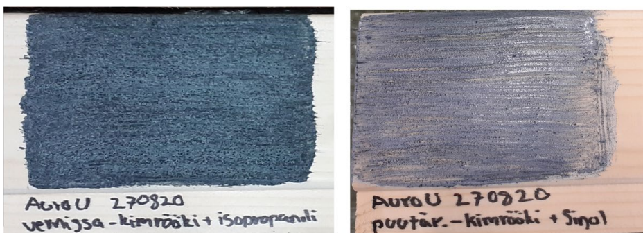
Kuva 6. Kimrööki-puutarättitahna ei sekoittunut kunnolla Auro-U-maaliin Sinolin lisäyksen jälkeenkään, vaan väritahna pysyi pistemäisinä palloina maalin joukossa. Isopropanolin lisäys vernissa-kimröökitahnan joukkoon tuotti samankaltaisen tuloksen – väritahna erottui selkeästi maalista. (Kuva Satu Huurtomaa.)
