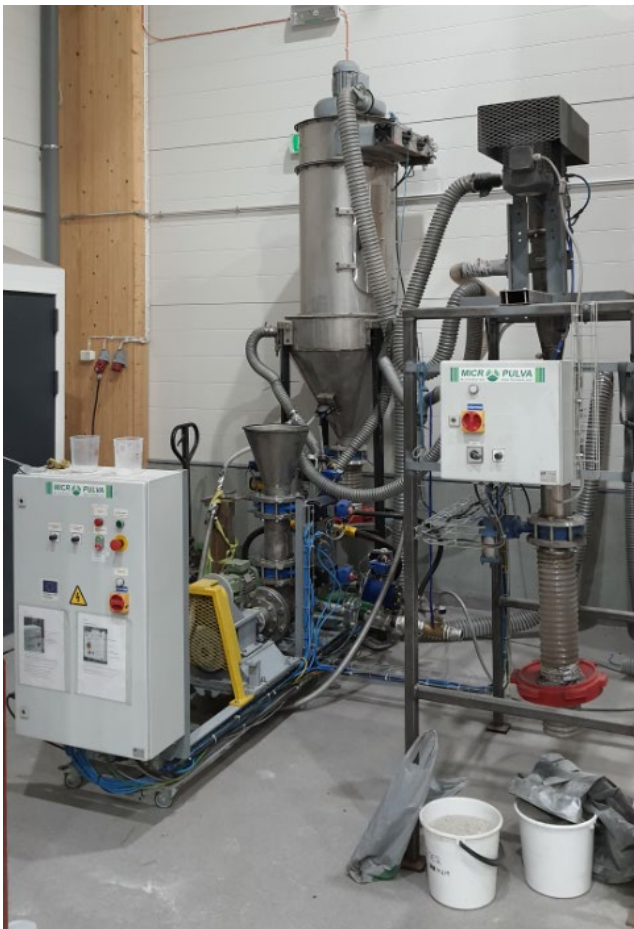
Kuva 5. Micropulvan toimittama FP1, 2-faasiteknologiaan perustuva jauhinlaitteisto, BioSampo-tutkimuskeskuksessa. (Kuva Tomi Höök.)
