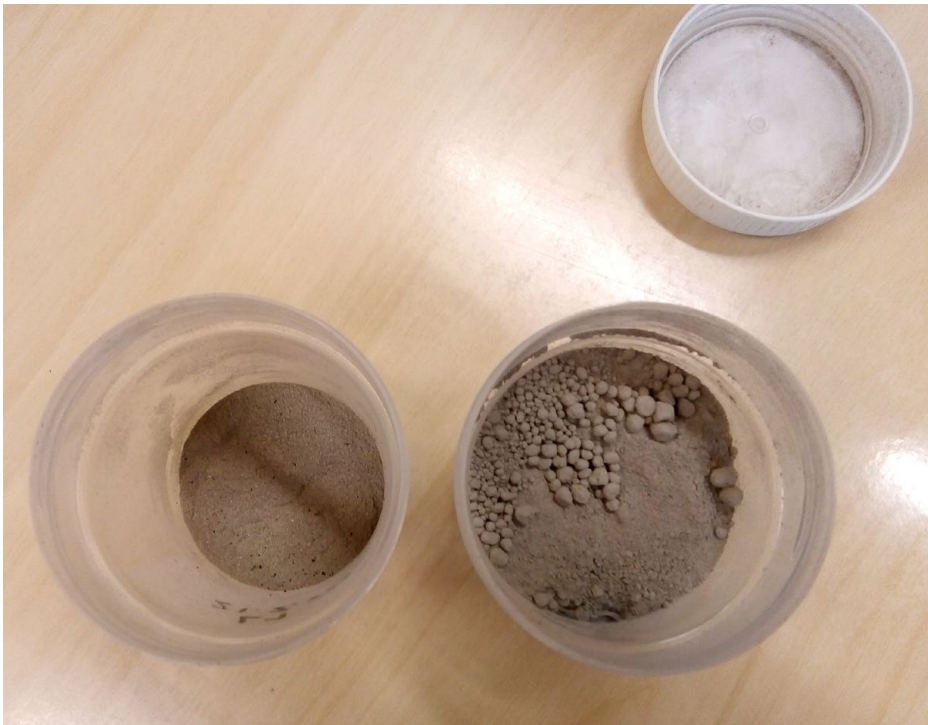
Kuva 10. Vasemmanpuoleisessa astiassa on käsittelemätöntä lentotuhkaa, kun taas oikeanpuoleisessa astiassa nähdään sama materiaali neljä kertaa mikronisoituna. (Kuva Evelliina Kuokkanen.)
