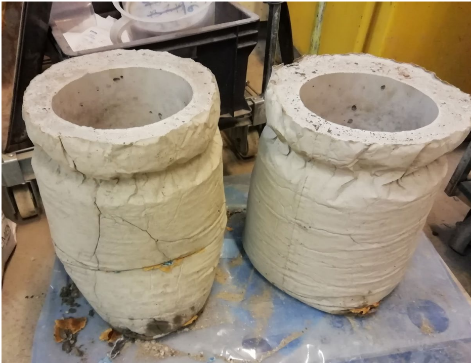
Kuva 4. Säkkeihin valettuja betonituotteita KymiLabsin betonilaboratoriossa. 20 prosenttia sementistä on korvattu K-ajojen tuhalla. (Kuva Anna Eskola.)
