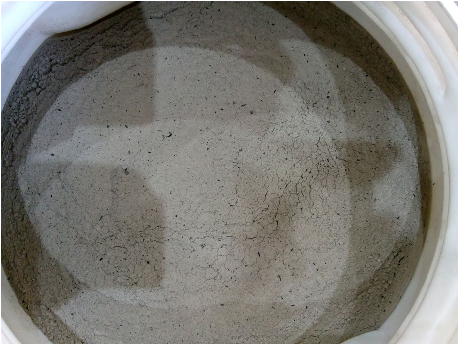
Kuva 1. Hienonnusajoissa käytetty biolentotuhka. Tuhkan joukossa näkyy mustia, pitkänomaisia hiilipartikkeleita. (Kuva Eveliina Kuokkanen.)
