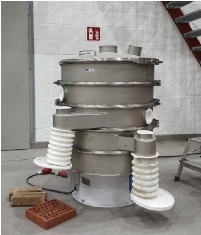
Kuva 9. Täryseulalla voidaan seuloa epäpuhtaudet pois jauhattavan materiaalin joukosta ennen mikronisointia. (Kuva Tomi Höök.)
