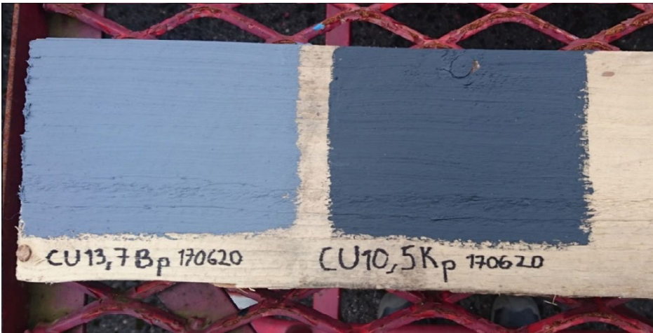
Kuva 1. Valmis valkoinen vesiohenteinen seinämaali jäi sävyltään harmaaksi sekä biohiilen että kimröökin tapauksessa. Vasemmanpuoleinen koeala on maalattu maalilla, jossa on biohiiltä 13,7 painoprosenttia maalista. Oikeanpuoleisen koealan maalissa on kimröökä 10,5 painoprosenttia. Maali, jossa käytettiin pigmenttinä biohiiltä, jäi sävyltään selkeästi vaaleammaksi. (Kuva Satu Huurtomaa.)
