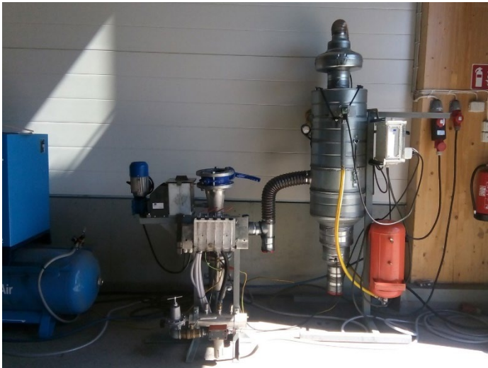
Kuva 8. Xamkin kehittämän loop-jauhimen toinen versio, jossa laitteistoon on lisätty jauhettavan materiaalin syöttösiilo ja -ruuvi. (Kuva Tomi Höök.)
