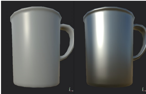
Kuva 13. Vasemmalla ei metallisuuskarttaa, oikealla käytössä metallisuuskartta.
