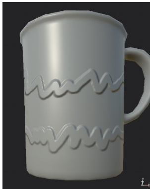
Kuva 15. Materiaalissa on korkeusinformaatiota. Reunoista voidaan kuitenkin nähdä, että materiaali ei vaikuta objektin geometriaan.
