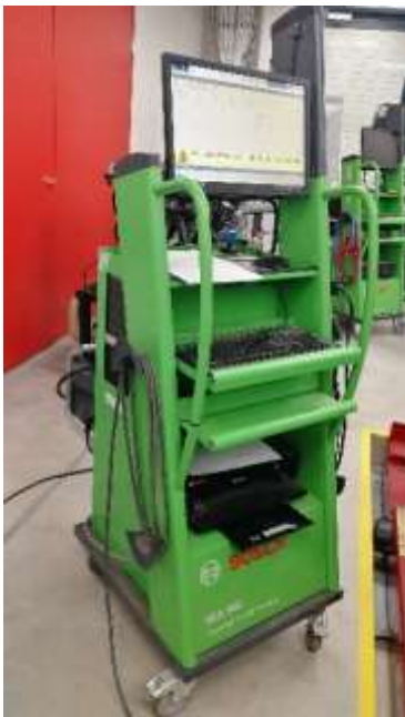
KUVA 16. Bosch BEA 950 -pakokaasuanalysointilaitte
