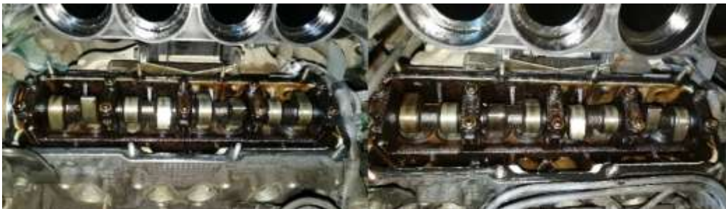
KUVA 29. Venttiilikoneisto, lähtötilanne vasemmalla
