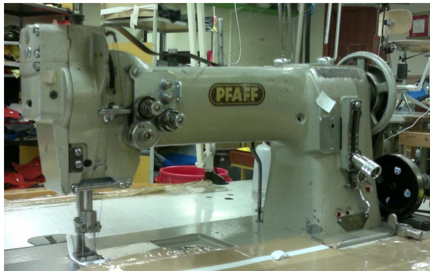
KUVA 6 Kuminauhan ompeluun tarkoitettu kone
