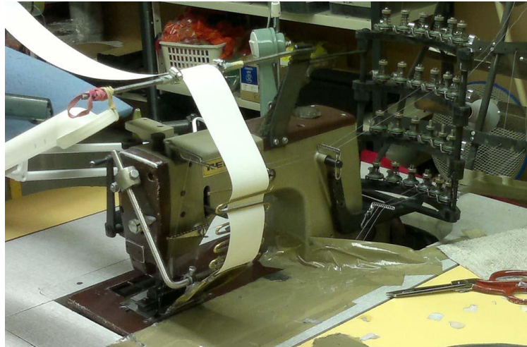
KUVA 5 Heijastimen ompeluun tarkoitettu kone
