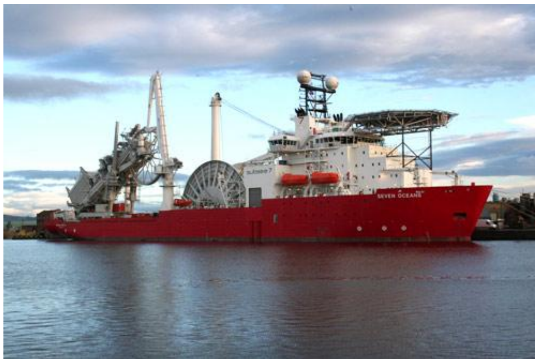
Kuva 10. Putkenlakualus Seven Oceans (offshore-technology, 2010)
