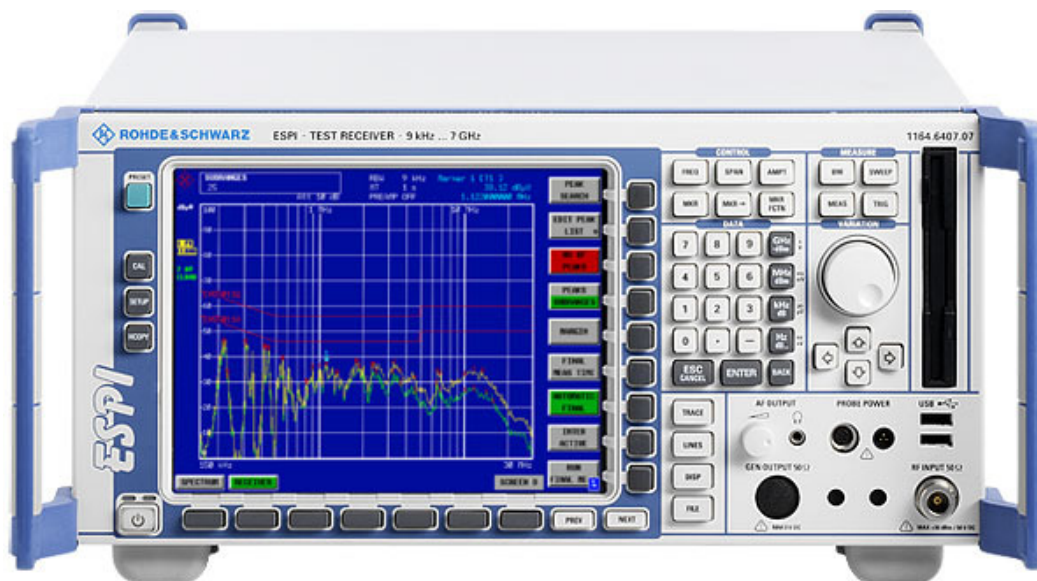
Kuva 3. Rohde & Schwarzin spektrianalysaattori (Rohde & Schwarzin verkkosivut 2011)
