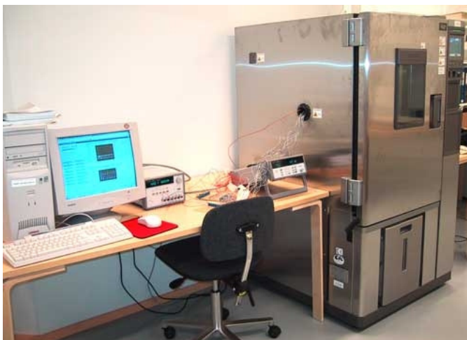
Kuva 2. Sääkaappi Rauman EMC-laboratoriossa (Satakunnan ammattikorkeakoulun verkkosivut 2011)
