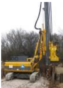
Kuva 5. Täryjuntta RG 19-T (Bauer 2001.)
