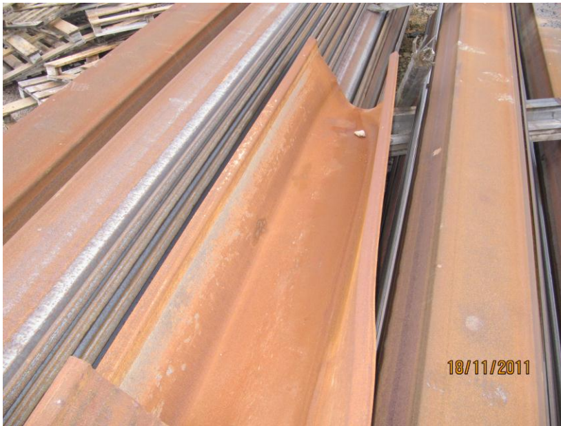
Kuva 17. V-muotoiseksi painunut pontti
