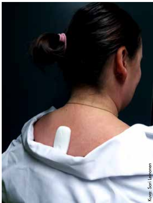
Kuva 1. "Upright GO"-anturi yläselkään kiinnitettynä.
