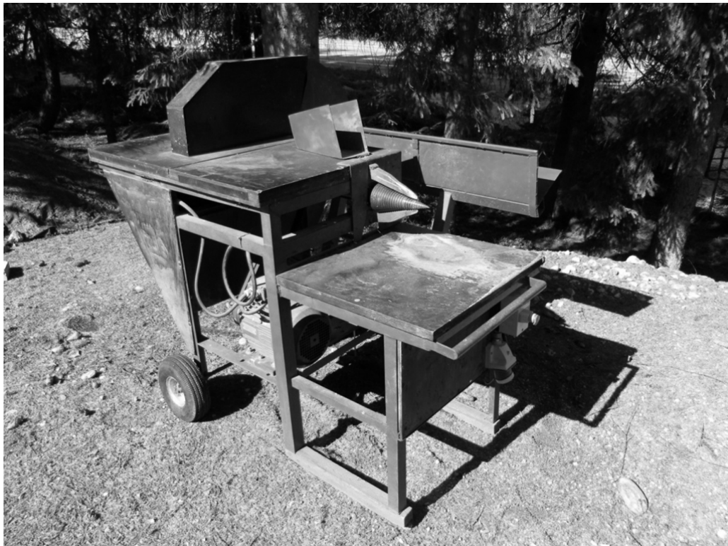
KUVA 5. Itse rakennettu halkaisukone.
