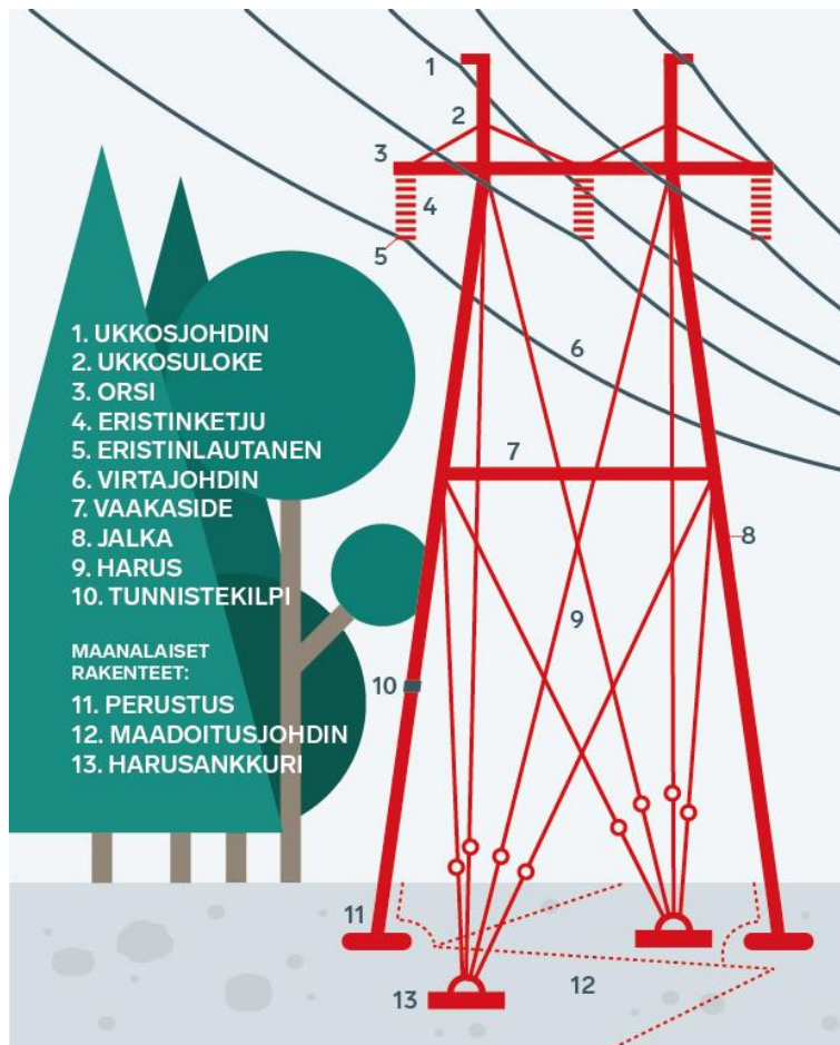
Kuva 2. Harustettu putkipylväs ja sen osat.
