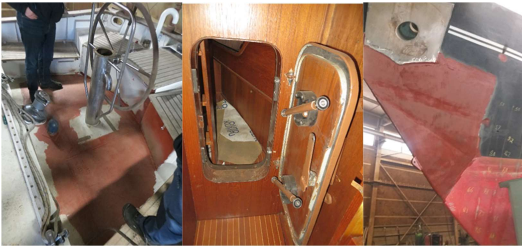
KUVIO 7. Keulan ja perän terästyöt pohjamaalattuna sekä laipion #1 luukun uusi sulkumekanismi.
