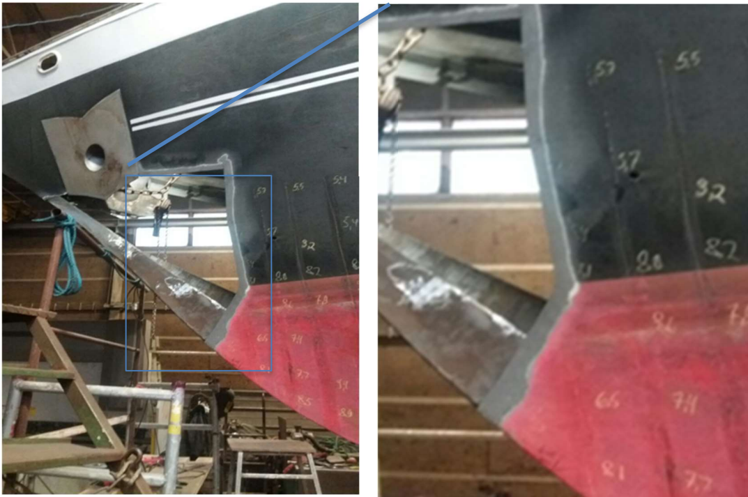
KUVIO 6. Keulan vaurioalue purettuna ultraäänitarkastuksen jälkeen.
