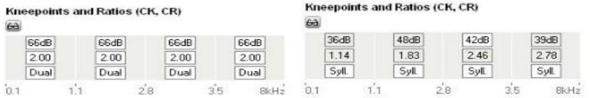
Kuva 5. Kaksois- ja tavukompressiot, niiden kompressiotasot ja kompressiokyynykset [1]
