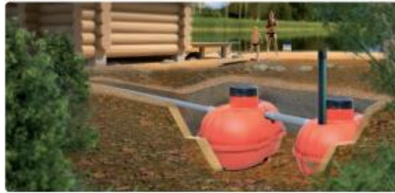
Saunasta pesuvedet johdetaan saunakaivoon ja kaivosta eteenpäin maaperään puhdistumaan. Mökkikaivo erottelee tiskivesistä kiinteät aineet sekä rasvan. Selkeytyneet vedet johdetaan eteenpäin saunakaivoon imeytettäväksi.
