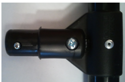
Figur 10. Koppling mellan mast och tvärrör samt mast och y-rör (foto, N. Ålander)
