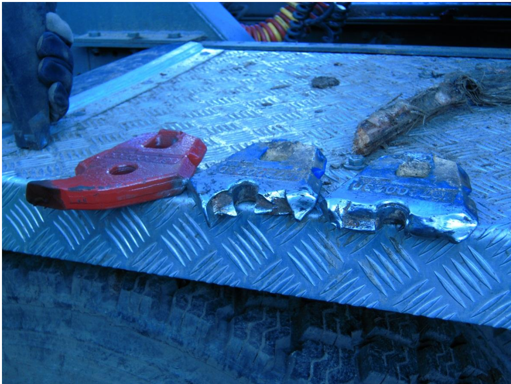
Kuva 7. Uusi terä ja kaksi loppuun käytettyä terää.
