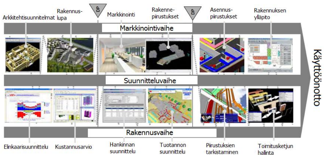
Kuva 5. Virtuaalisen rakennusteknologian ja suunnitelmien käyttö hankesuunnitteluvaiheessa (15, s. 15).
