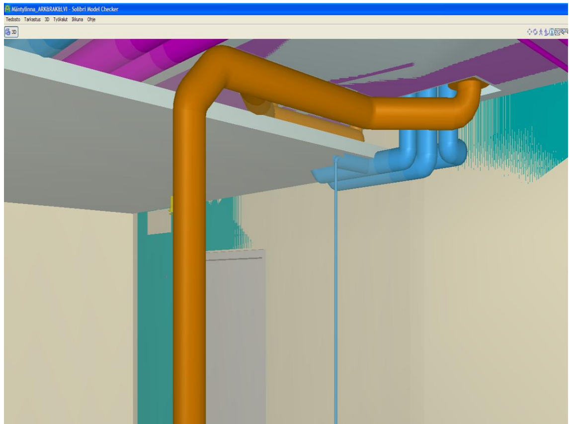
Kuva 15. Solibri Model Checker-ohjelmiston esille tuoma suunnitteluvirhe (13)
