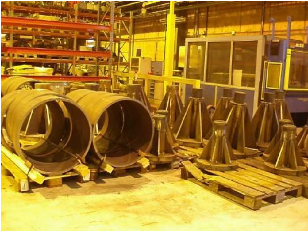
KUVIO 8. Ulkopuolisia vahvikepantoja ja kärkiä (Kuva: Katja Dahl)
