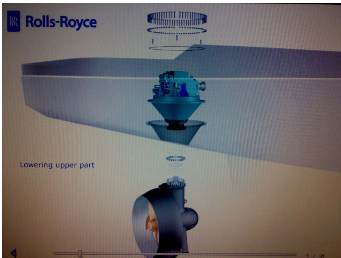
Kuva 23. Bolted Conical Well -asennus.
