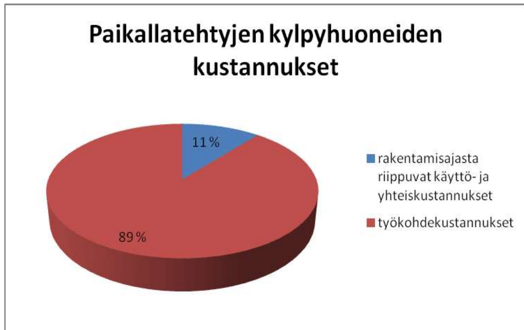
Kuva 7.3 Paikallatehtyjen kylpyhuoneiden rakentamisajasta riippuvaisten käyttö- ja yhteiskustannusten osuus kokonaiskustannuksista
