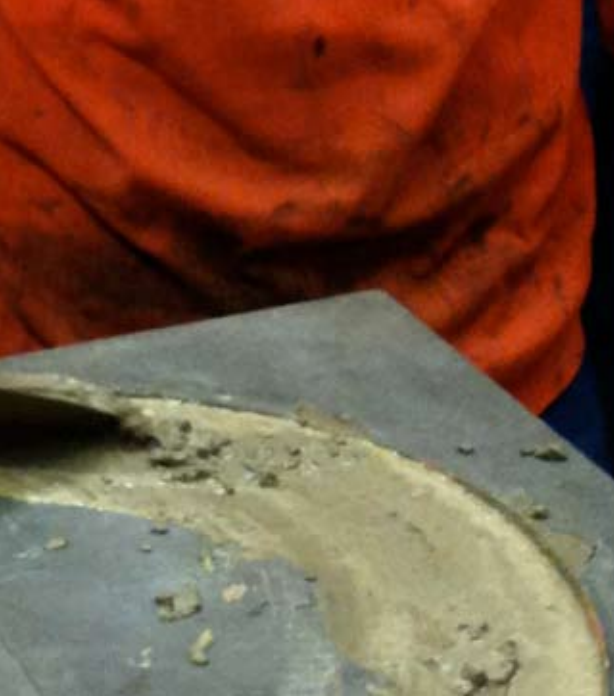
Massan ja muotin pinta täytyi lopuksi siistiä ylimääräisistä roiskeista.
