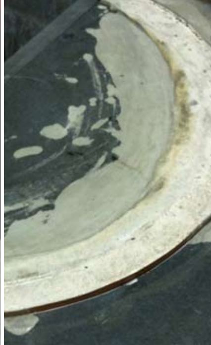
Massan ja muotin pinta täytyi lopuksi siistiä ylimääräisistä roiskeista.
