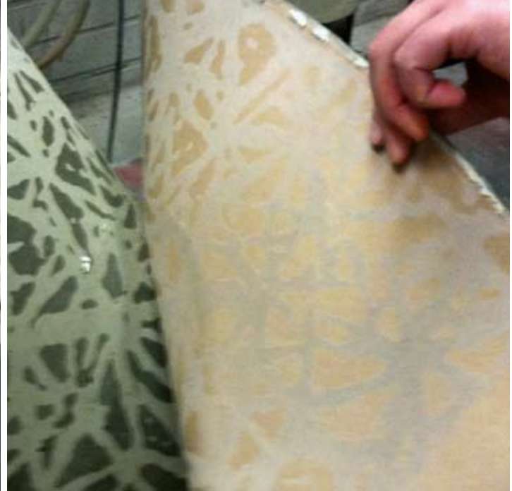
Elementillä on vuorokauden kuivumisaika muotissa. Jos aika pitenee, saattaa kalvo ns. palaa kiinni betoniin.
