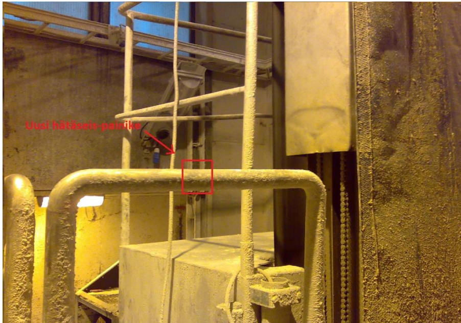
KUVA 14. Uuden hätäseis-painikkeen sijoituspaikka suodattimen takana (Joonas Rautiainen 2011)
