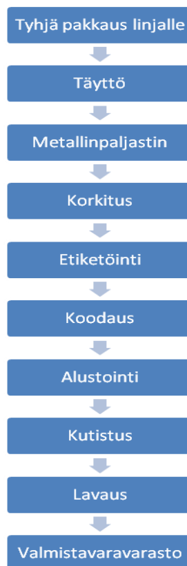
KUVA 1. Fillpak-pullonpakkauslinjan prosessikaavio
