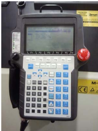
Kuva 5. Fanuc -robotin käsiohjin. TAO T.Mikkonen 2012
