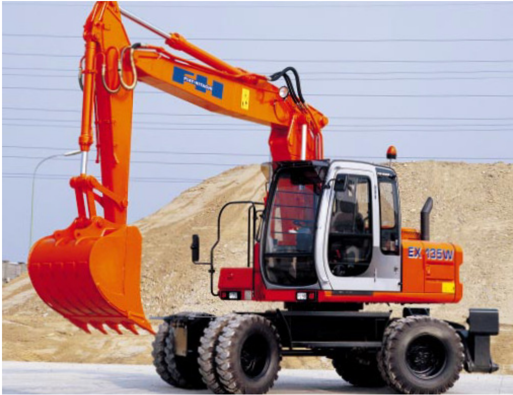
Kuva 3. Pyörälustainen 15 t kaivinkone /1, s. 3./
