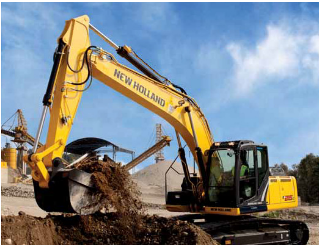
Kuva 2. Tela-alustainen 23t:n kaivinkone /10, s. 1./
