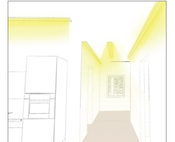
Kuva 78. Käytävässä wallwasherit antaa valoa seinän kautta, lisäksi voi käyttää myös kattoon upotettua loisteputkivalaisinta.
