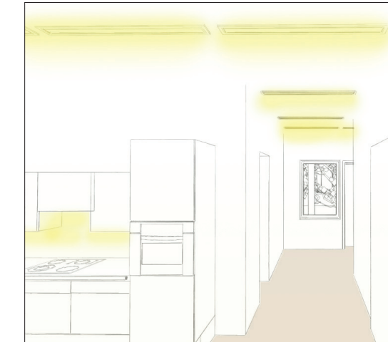
Kuva 77. Upotetut loisteputket vaakasuunnassa saa käytävän näyttämään lyhyemmältä, mutta vaikutelma voi ikääntyneelle olla levoton ja rasittaa silmiä.
