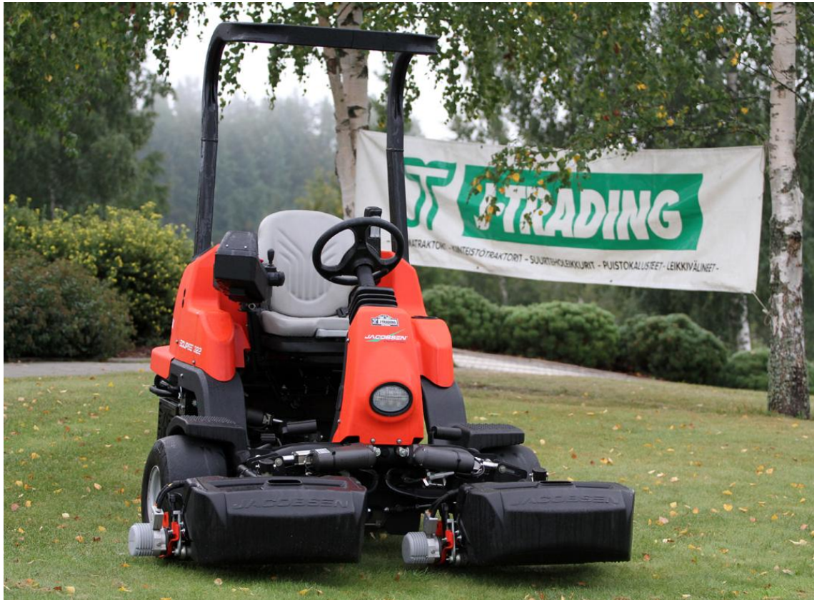
Kuva 5. Täysin sähkökäyttöinen leikkuri, Jacobsen Eclipse 322
