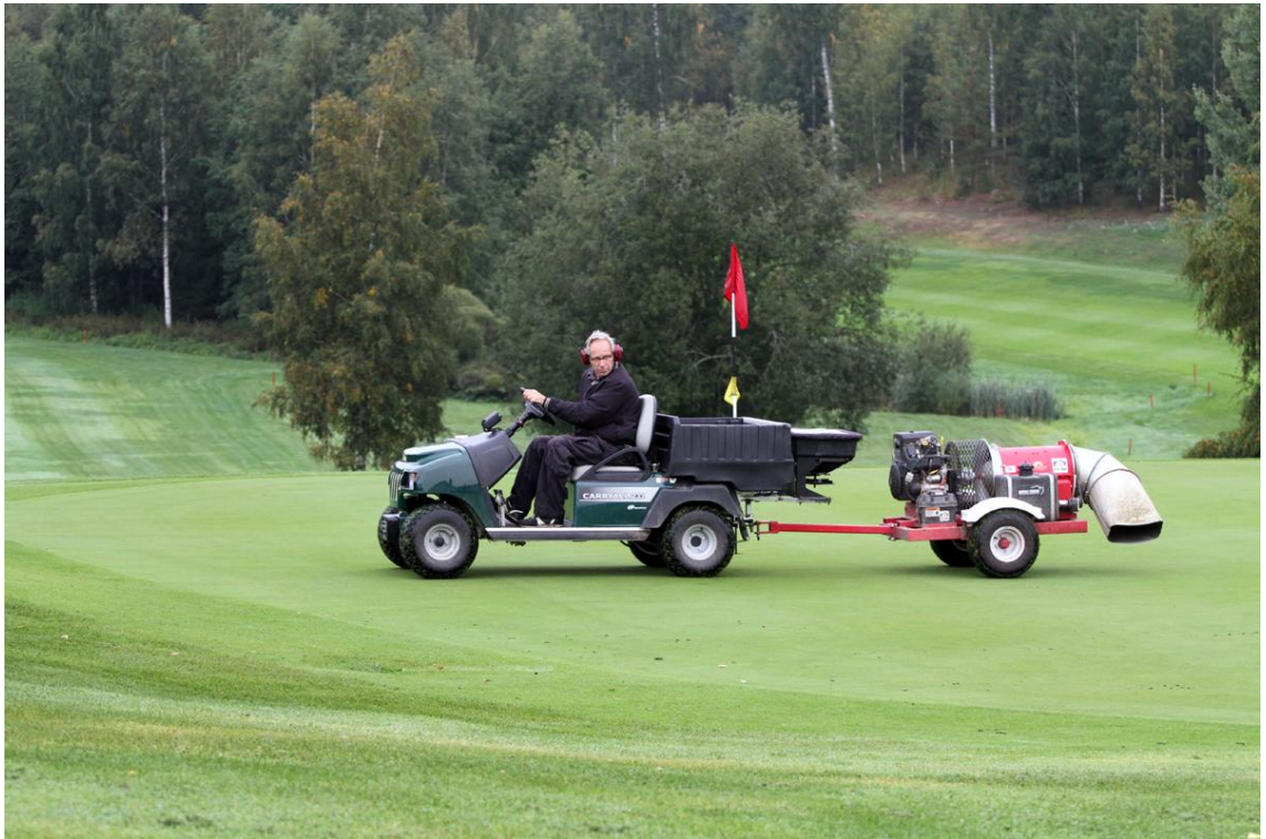
Kuva 7. Sähkötoiminen kuljetin, johon on liitetty lannoitelevitin ja vetokoukkuun kiinnitettyinä on lehti-leikkuujätepuhallin.
