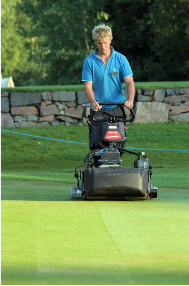
Kuva 9. Jacobsenin perässä käveltävä akkukäyttöinen telaleikkuri Eclipse 100
