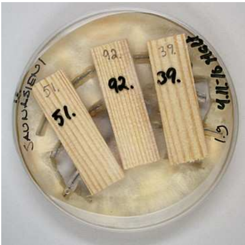
Kuva 5. Saunakääpä normista sovelletussa laboratoriokokeessa. (Kuva: Eija Matikainen.)
