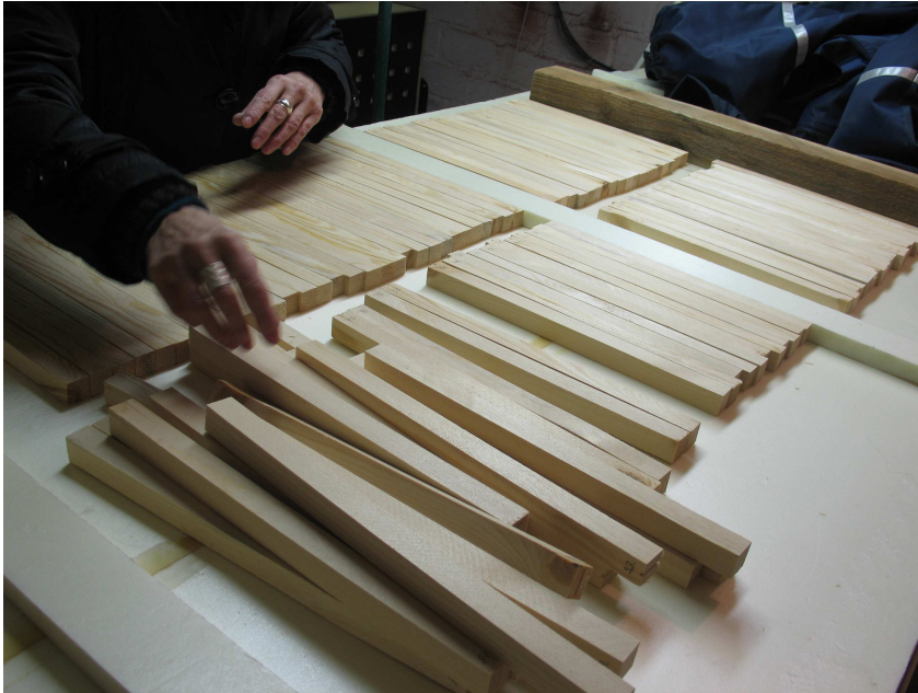
Kuva 8. ISO 3133 -standardin mukaisia 20 x 20 x 340 mm:in puukappaleita. (Kuva: Martti Venäläinen.)
