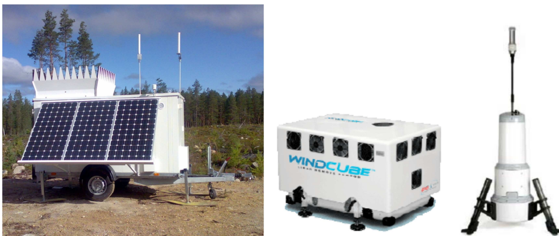
Kuva 8. Vasemmalla Sodar-äänitutka [20, s. 2.], mittaa äänipulssin avulla tuulen nopeutta ja suuntaa. Oikealla Lidar- lasertutka[]. Molempien mitta-alueet ulottuvat 200 m asti eivätkä ne vaadi minkäänlaisia mastorakenteita.
