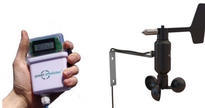
Kuva 39. Opinnäytetyön tuulimittauksissa käytetty Power Predictor tuulimittauslaite [19].
