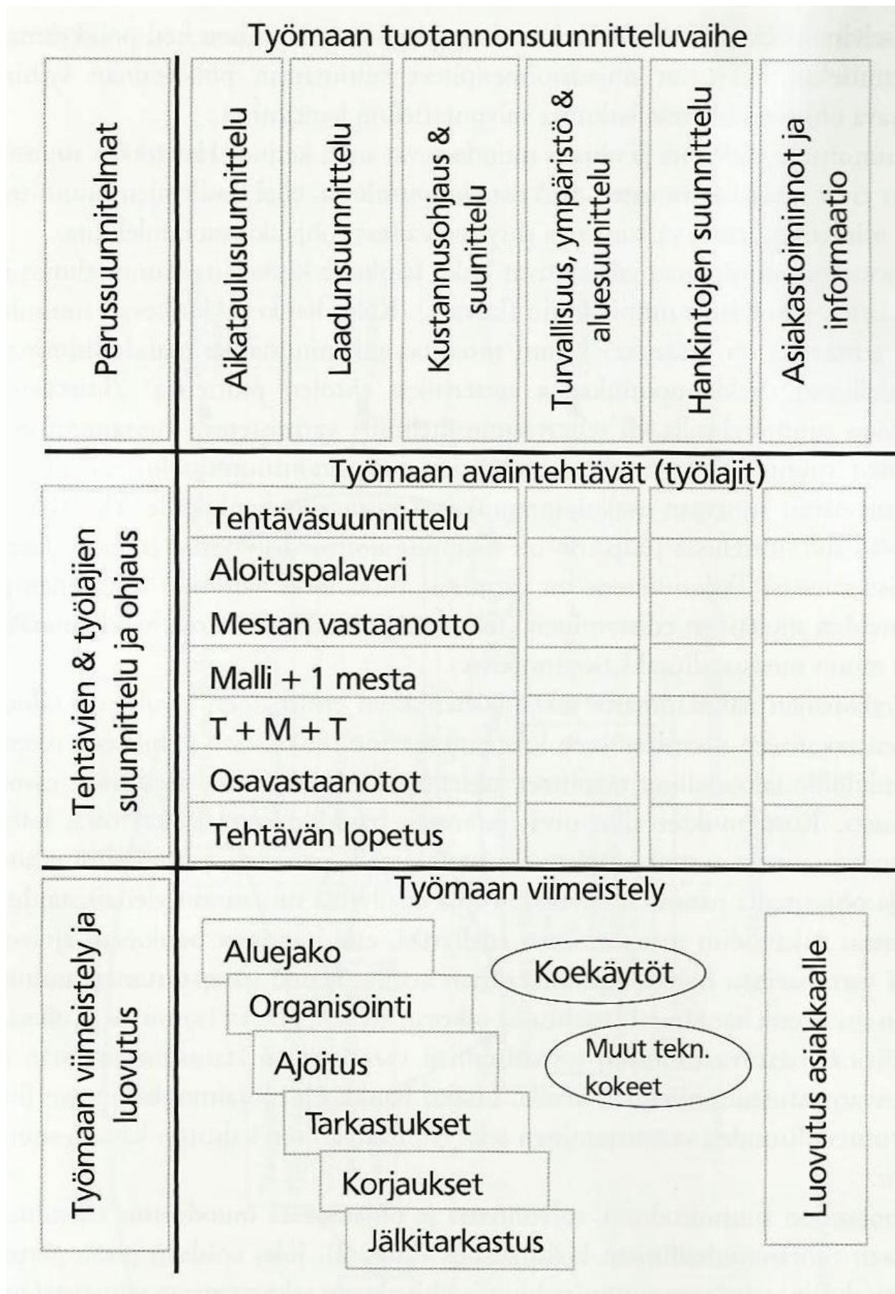
Kuva 2. Rakennustyömaan tuotannon suunnittelu ja ohjaus (2, s. 10)
