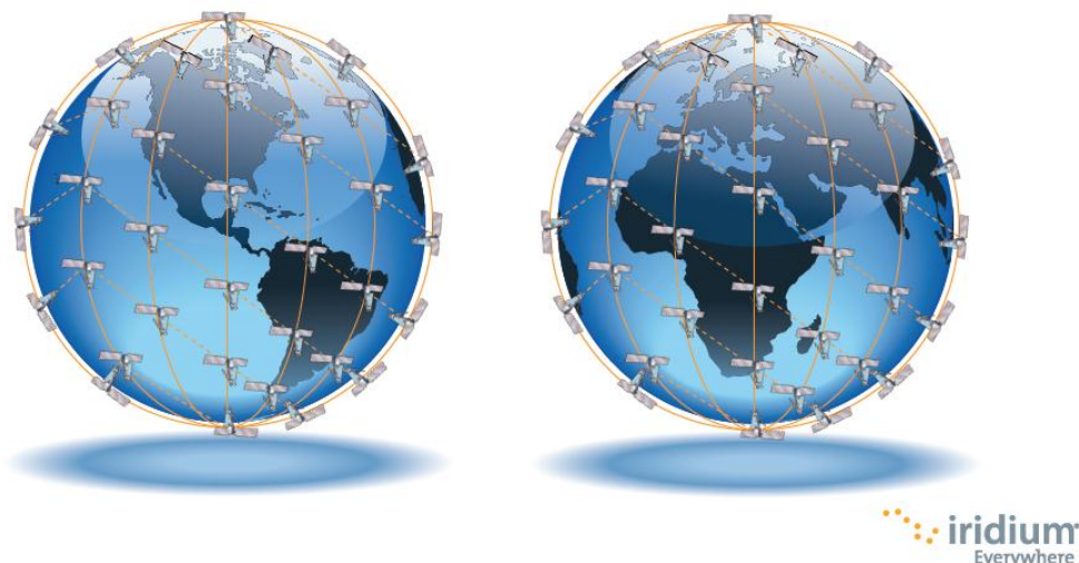
Kuva 1. Iridiumin maailmanlaajuinen LEO-satelliittijärjestelmä (Iridiumin www-sivut 2012).
