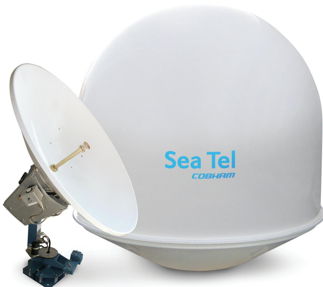
Kuva 4. Sea Tel 5004 TVRO -televisioantenni ja -suojakuori. Antennilautasen halkaisija 1,27 m ja kokonaispaino 95,3 kg (Cobham:in www-sivut 2012).
