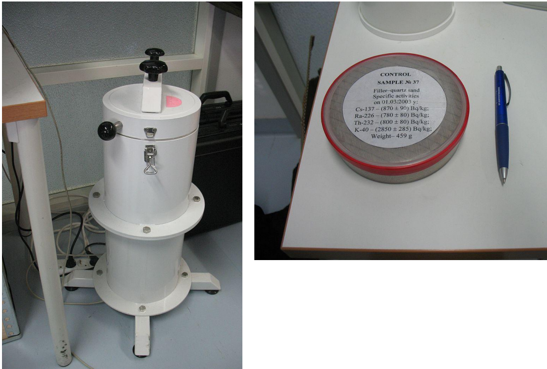
Kuva 5. Työssä käytettävä NaI-gammaspektrometri (vasemmalla) ja mittauksissa käytetty 320 millilitran näytenpurkkigeometria (oikealla).
