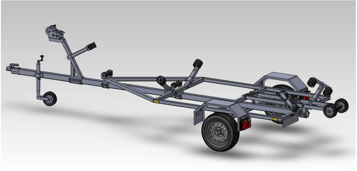
Kuva 13. Yhtenäinen kokoonpanokuva venetrailerista.
