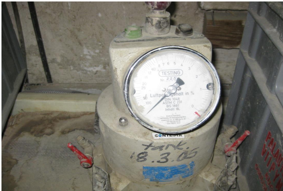
Kuva 6. Betonin ilmamäärän mittauslaite
