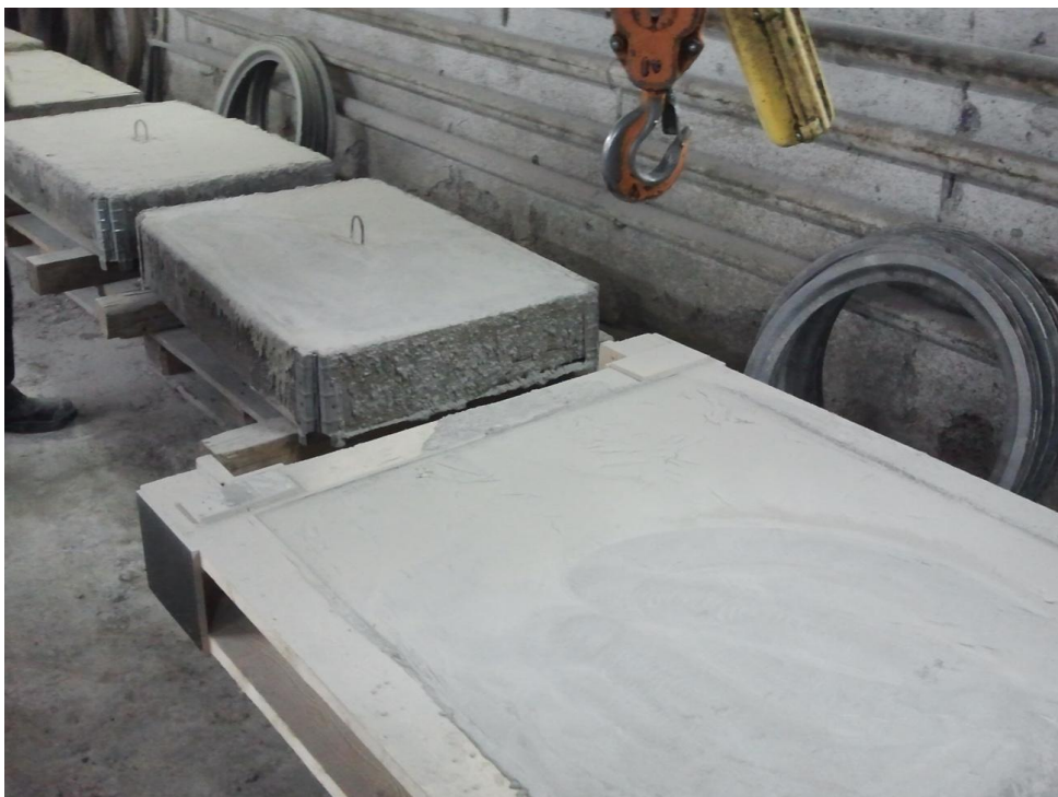
Kuva 10. Betonilaattojen pinnat hionnan jälkeen.
