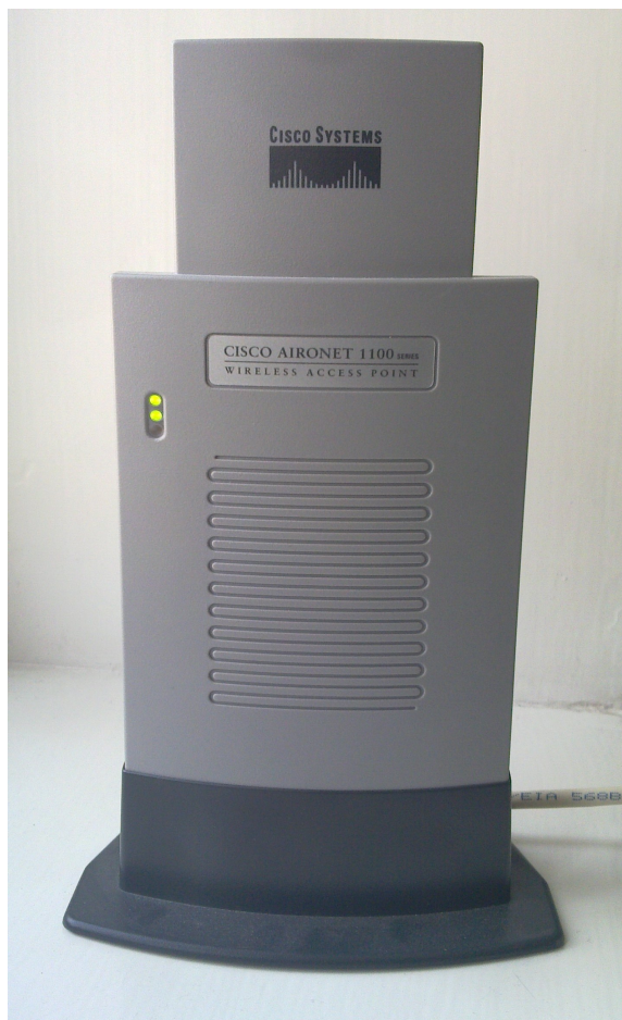
Kuva 5: Käytössä oleva Ciscon 1121G-tukiasema
