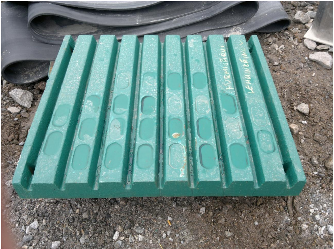
KUVA 4. C125 leukamurskaimen käyttämätön kovapalaterä (Mikko Härkin 29.3.2012)
