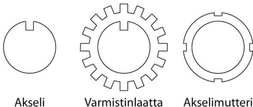
Kuva 64. Akselissa tulee olla ura varmistinlaatan sakaraa vasten.
