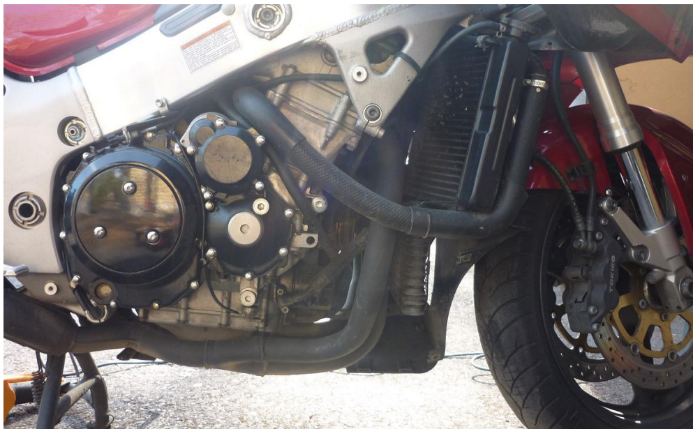
KUVIO 16. Ahtimelle luonnollisin sijoituspaikka on koneen etupuolella, jossa on valmistajan jäljiltä ahdasta.
