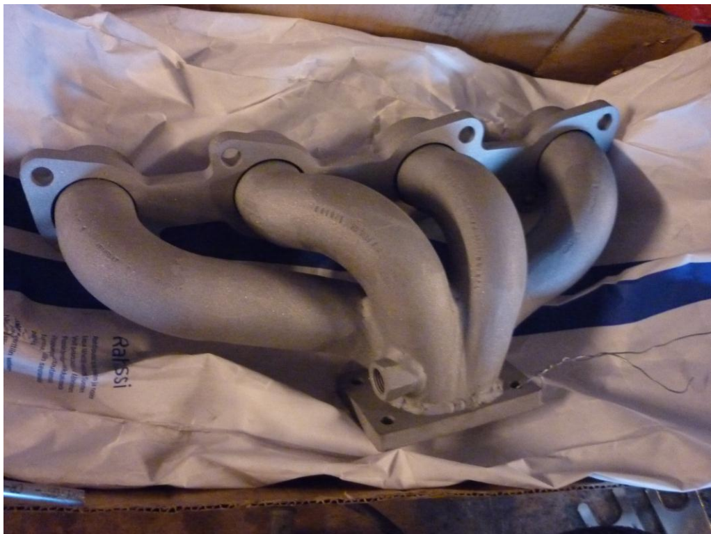
KUVIO 19. Alumiinioksidilla puhallettu ja pinnoitusta vaille valmis pakosarja.
