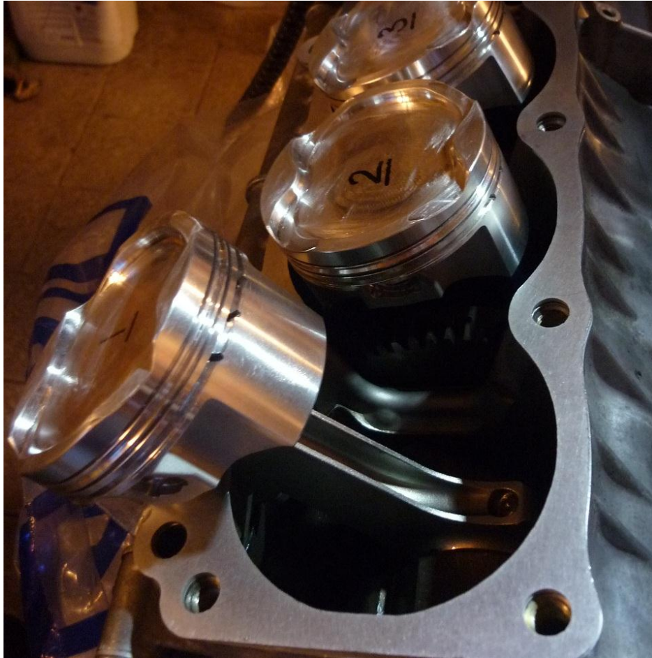
KUVIO 25. Turbokäyttöön tarkoitetuilla matalapuristeisilla männillä saadaan muiden etujen lisäksi puristussuhdetta laskettua pilaamatta paljealuetta. Huomaa tasainen männän laki ja reunoilla oleva korkea tasainen alue.
