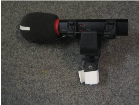
Kuva 3. Kehdossa tuulisuojalla varustettu Sennheiser MKH50 ja sen suuntakuvio.
