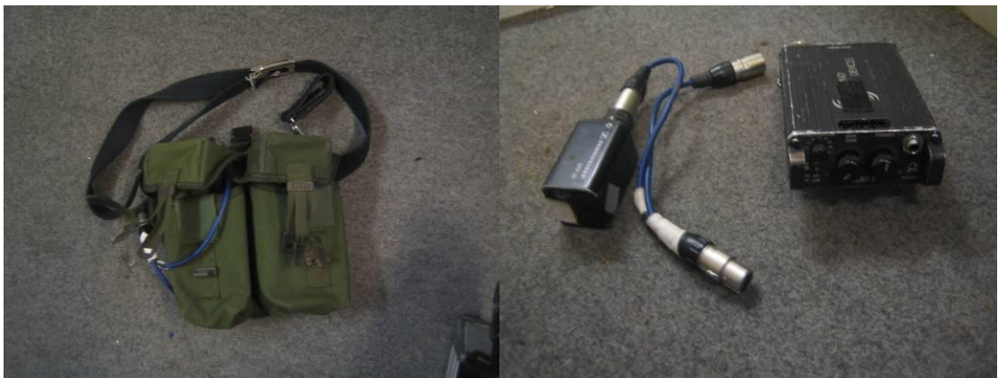
Kuva 8. Varustevyö, Sennheiserin SKP 30 langaton lähetin ja Sound Devicesin MM-1 mikrofonetuvahvistin
