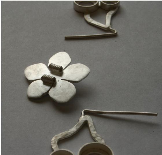
KUVA 29. Kuvassa oksakappaleiden päissä on juotettuna ja valmiiksi taivutettuna langat, jotka kulkevat spiraaliputkien (kukassa) lävitse muodostaen saranamekanismin. Valokuva Kirsi Kauppinen 2012
