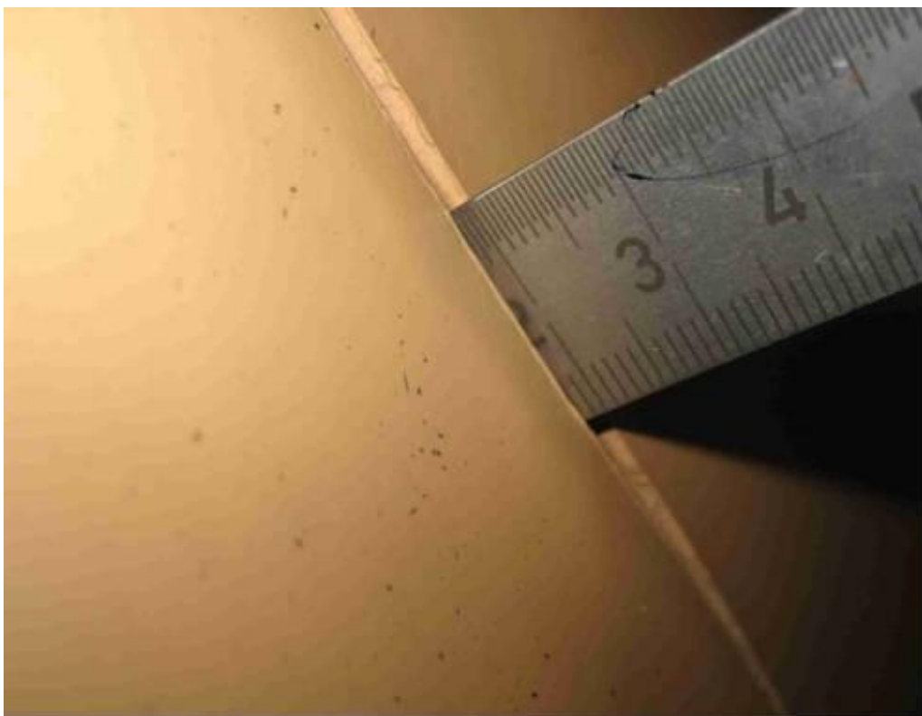
Kuva 32. Rullassa 20 mm syvä halkeama.
