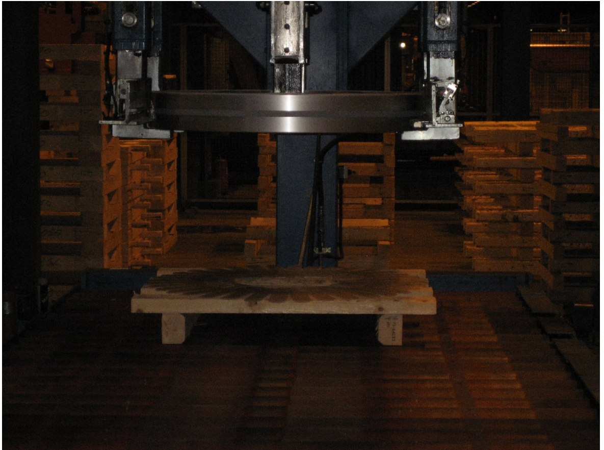
Kuva 8. Lavausrobotti Veijo laskemassa kaistaa alustalle.
