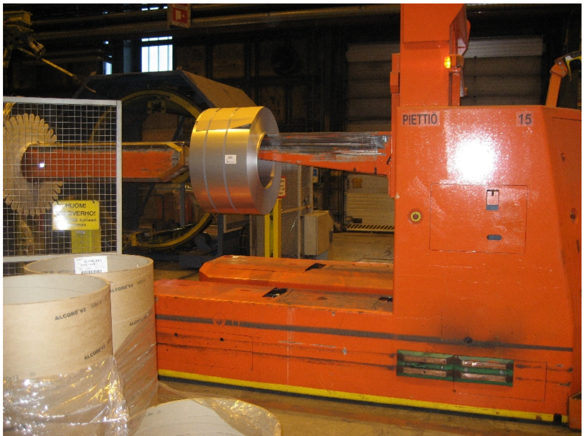
Kuva 6. Tuurnavihivaunu tuo rollan vaakapakkauksen ristille.
